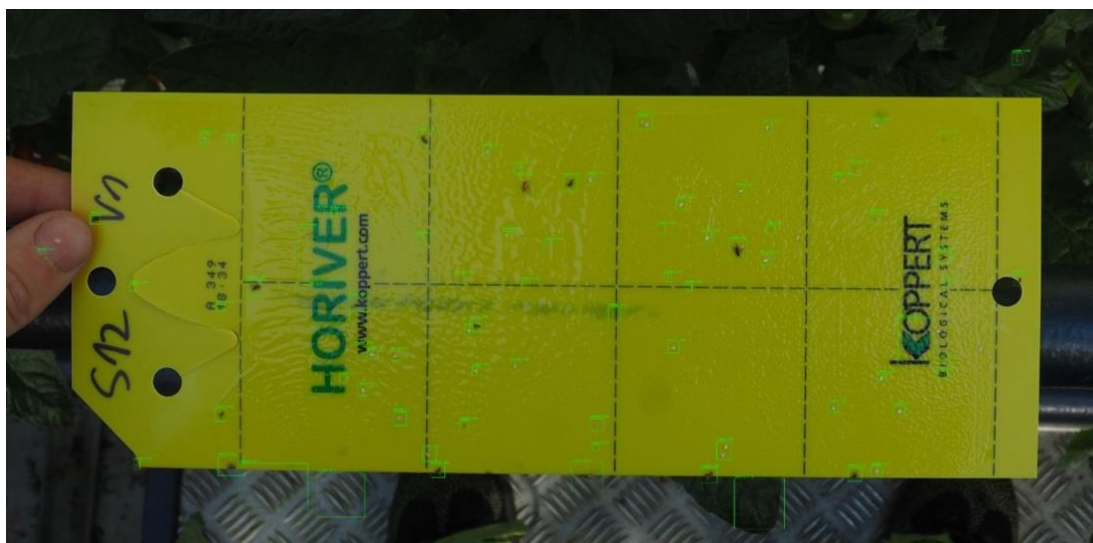
Obr. 4: Příklad detekce škůdců na snímku žlutého lepeného štítku z testovací množiny
